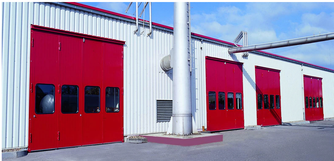
4-flügelige Toranlagen, Teilung 2:2, 2 links ohne obere Führung, rechts angelenkt, abgerundete Verglasung
