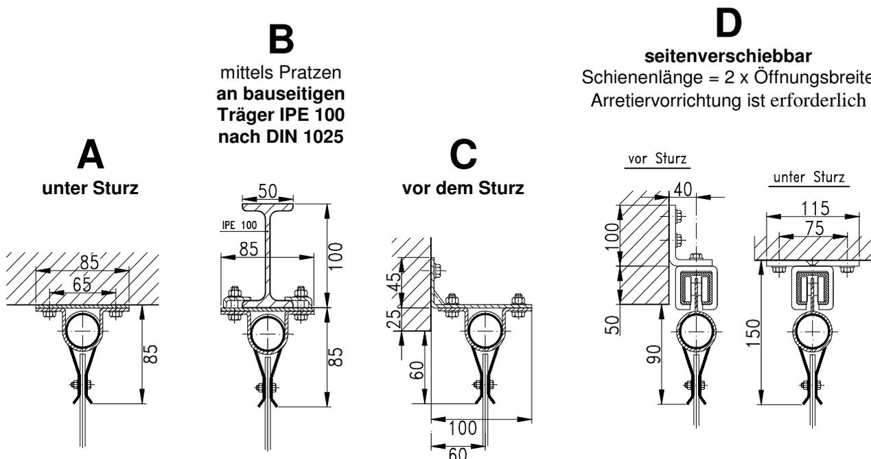
Als Sonderausführung ist die Befestigungsart „D“ auch elektrisch verschiebbar möglich.
