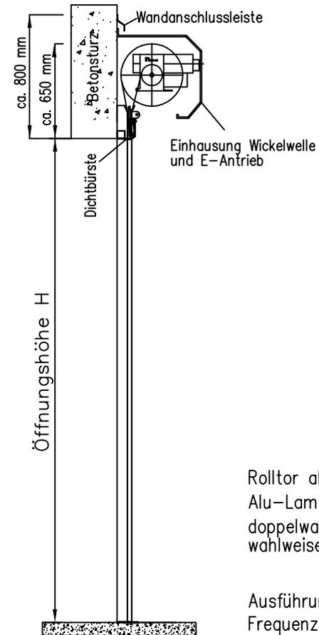
Rolltor als selbsttragende Konstruktion
