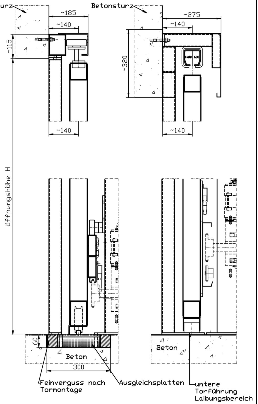
Steuerung wahlweise als Totmannsteuerung, Impulssteuerung oder automatische Schließfunktion. gesamte Toranlage verzinkt, grundiert und Farbendbeschichtet im RAL- oder DB-Farbtönen nach Wahl. Betongüte des Fundaments min. C20/25
