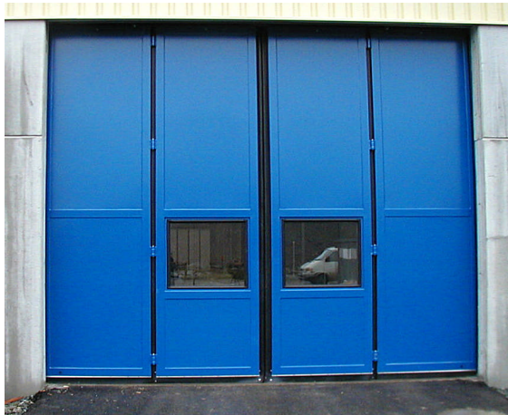
SFE 1000 mit eingelassenen Blechen und Sicherheitsverglasung P7B mit verstärkten Profilglasleisten (Torx-verschraubt)
